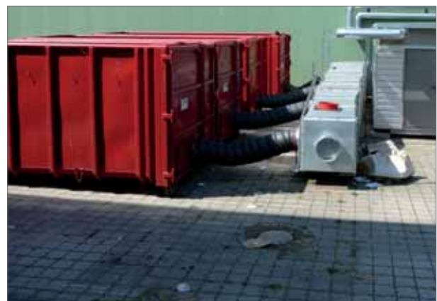
Containertrocknungsanlage für Biomasse.
