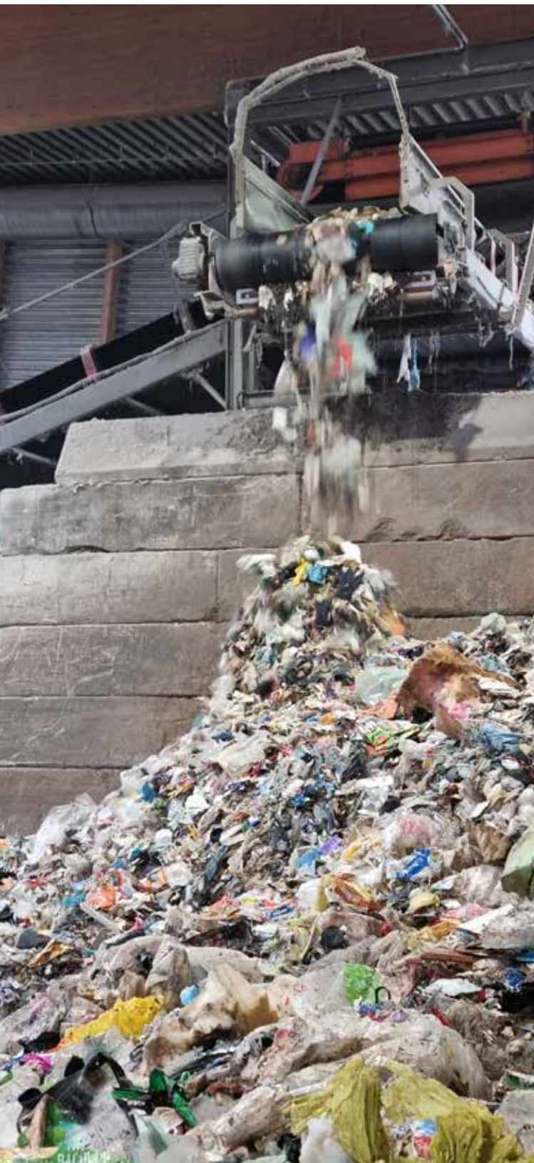
Heizwertreiche Fraktion aus der mechanischen Aufbereitungsanlage der MBA für die thermische Verwertung
